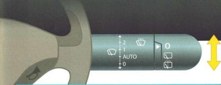
**05/69** Faites fonctionner les essuie-glaces avant du véhicule sur la position la plus rapide.
